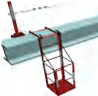
4.1.5 楼层间人员及小型机具转移时可采用钢斜梯提供安全通道。扶手、中间栏杆的高度分别为 1200mm 和 600mm，立柱间距不大于 2000mm。立柱与连接板焊接形成整体，栓接于梯梁上。
