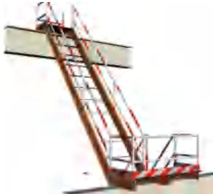
4.1.6 楼层内人员及小型机具转移时可采用定型钢跳板提供安全通道；上、下两道钢丝绳距离通道面的净距离分别以 1200mm、600mm 为宜；通道临边防护应采用Φ9 镀锌钢丝绳，通过绳卡与花篮螺栓连接，绳卡不少于 3 个，
