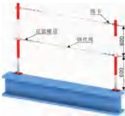
4.1.8 钢柱间可使用抱箍式双道安全绳做临边安全绳防护，上下两道钢丝绳距离梁面分别为 1200mm、600mm，端部钢丝绳使用绳卡进行固定。
